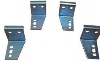
**Descripción:** Para el montaje de ángulos 19" (482,6 mm) en armarios de 600 mm de ancho. Ajustables en profundidad en pasos de 12,5 mm.
