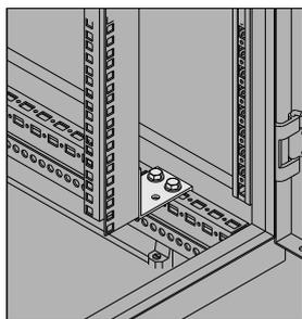
**Descripción:** Para montar perfiles de 19" en armarios de 800 mm.
