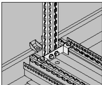
**Descripción:** Perfil con patrón de taladros para crear una división vertical en armarios de doble puerta y montar el equipo en la mitad del ancho.
